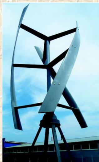
Рело, геометрия которого позволяет максимально использовать силу ветра, — пояснил изобретатель. — Опытный образец сделан из тонкого композитного материала, потому что он не несет большой нагрузки. При этом ветроголовка чувствует ветер скоростью 1 м/с, что в 2 — 3 раза меньше, чем обычно».
